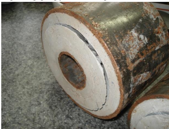
Рис.5. Характер разрушения образца с арматурными элементами
