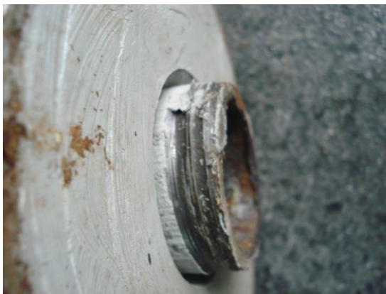
Рис.6. Характер разрушения образца с винтовой тягой
