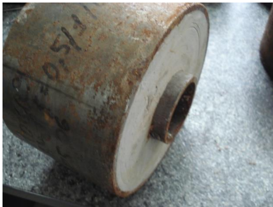
Рис.4. Характер разрушения образца с гладкой трубой
