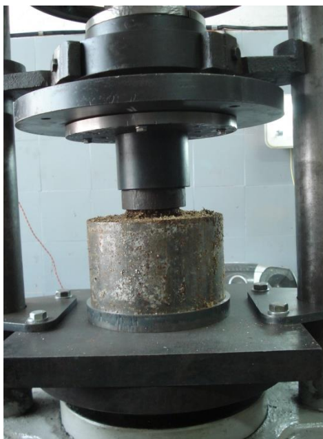
Рис.3. Испытательная установка на выдавливание трубы из цемента
